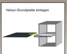
Vario System Module mit Klettband nach unten auf Velour-Grundplatte positionieren
